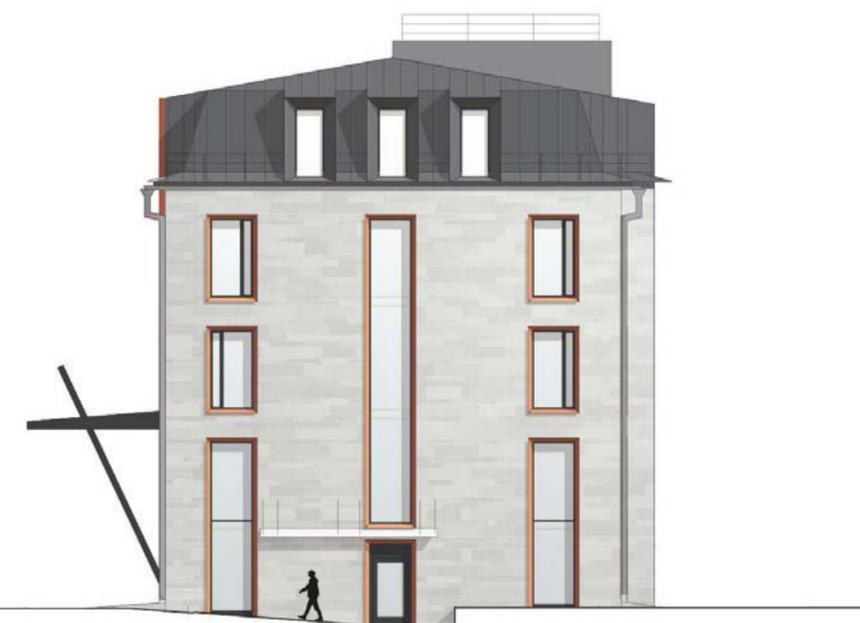
**Применение в архитектуре стекла и металла** — выгодный прием лофт-стиля, создающий к тому же деловую атмосферу и отвечающий темпам современности. В ходе реконструкции центральная часть фасадной стены была изъята и укреплена металлической обоймой. Полученный проем заполнили витражное остекление во всю высоту здания, что визуально выделило входную группу с монументальным козырьком на наклонных металлических опорах.
